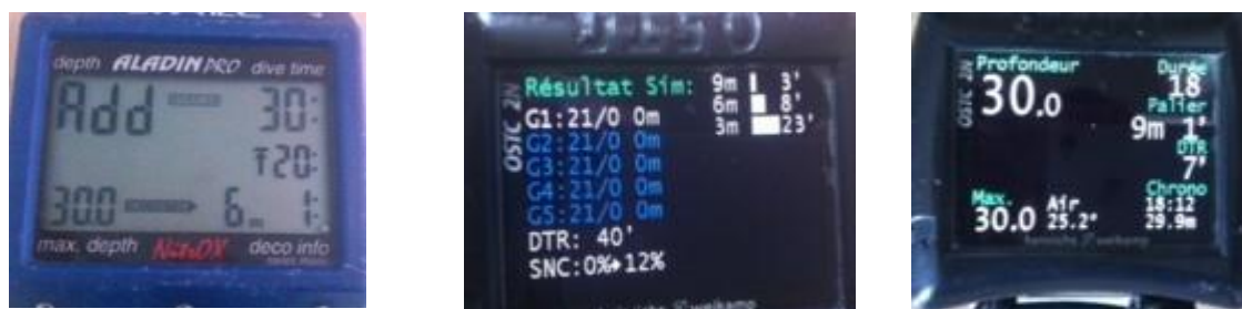
Simulation de paliers en mode surface : affichage 1 er palier, paliers totaux, simulation plongée en temps réel
