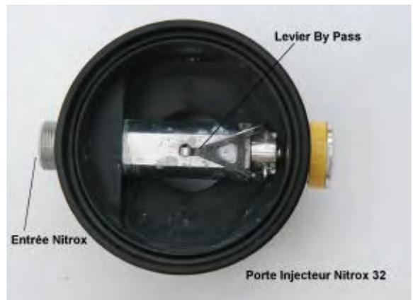
Avec un mélange Nitrox 50, l'injecteur du Ray est calibré à 8,25 L/min et permet de plonger jusqu'à 22m pendant environ 90' (en fait la capacité de la cartouche de chaux limite la plongée à environ 70').
