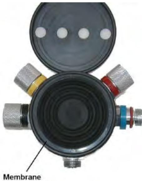
...qui laisse apparaître un mécanisme similaire à celui d'un deuxième étage de détendeur : c'est le levier de by-pass qui permet d'injecter directement du gaz dans les faux poumons à chaque augmentation de la pression ambiante.
