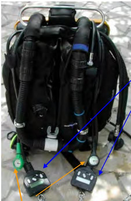
Manomètres de contrôle diluant et oxygène
