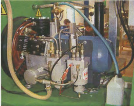
Mécanique de compression travaillant de 1b à 2.5b absolus à l'aspiration.
