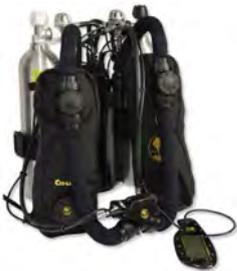
Commercialisé par Poséidon, il est petit et léger (18 kg) ce qui est pratique pour les voyages. Il est équipé de 2 bouteilles de 3 litres, d'un B.O.V et d'un affichage par diodes et vibreur (H.U.D). Il comporte une console avec ordinateur intégré. Les faux poumons se situent sur les épaules. Il est certifié C.E, et son prix actuel est de 5470 €.
