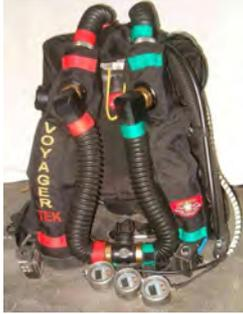
Commercialisé par Aquatek (Italie) d'abord en version SCR, il existe depuis plusieurs années en version CCR. Contrairement au Kiss et au rEvo, la moyenne pression est asservie à la pression ambiante, comme le premier étage d'un détendeur en circuit ouvert. Le débit d'O<sub>2</sub> est moins stable à la descente et doit être réglé en fonction de la profondeur prévue.
