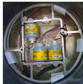
3 cellules à O<sub>2</sub> dans la tête du canister du rEvo
